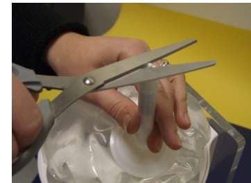
5 Mettre en place la cartouche après avoir sectionné le téton
